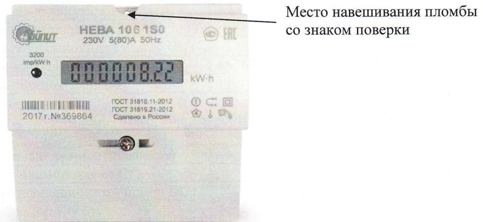
Рисунок 7 - Внешний вид модификации НЕВА 106 с местом опломбирования и местом нанесения знака поверки
